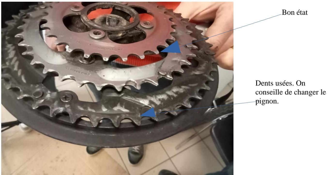
Une chaîne et un pignon ont une durée de vie d'environ 3000 km, tout dépend de l'usage. D'où l'intérêt de baisser ses vitesses aux feux, dans les montées, pour éviter le forçage.
