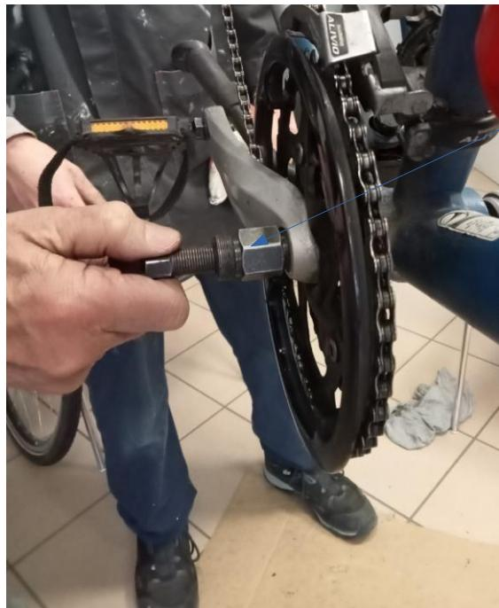
Les pédaliers se démontent à l'aide d'une vis d'extraction, ce qui permet de graisser aussi cet endroit.
