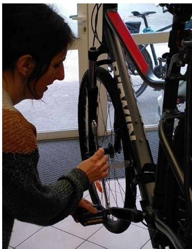
Attention au changement de pédales : sur la pédale gauche, serrage en sens inverse des aiguilles d'une montre.
